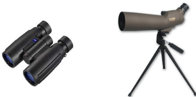
Figura 7. Instrumental óptico utilizado para los trabajos de censo. Prismáticos 10x40 y Telescopio terrestre 20x60x85.
